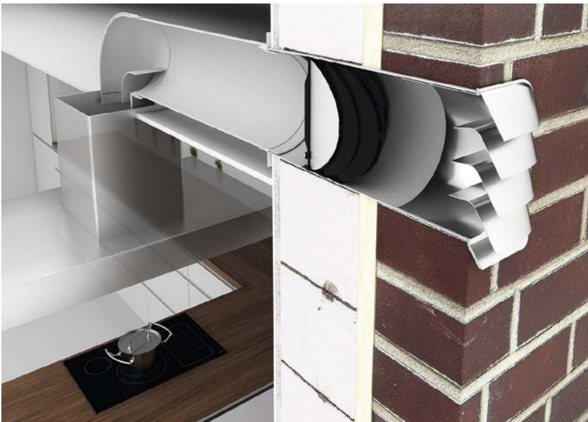
Foto 5: Intelligente Abluflösung, bei der die Effizienz der Dunstabzugshaube maximiert wird plus eines wärmedämmenden Effekts, wenn die Haube nicht in Betrieb ist. So wird ein Wert erreicht, der der Dämmleistung isolierverglaster Fenster entspricht. (Foto: AMK)
